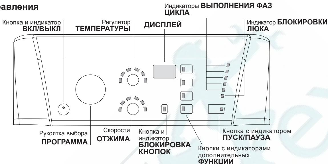
**Кнопка и индикатор ВКЛ/ВЫКЛ:** служит для включения и выключения машины. Горячий индикатор показывает, что машина включена.
