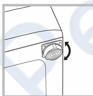
1. Установите стиральную машину на ровном и прочном полу, так чтобы она не касалась стен, мебели и прочих предметов.
